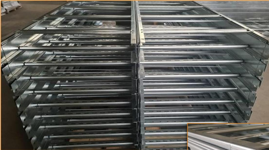
➤ Соединение продольных направляющих и поперечных перемычек происходит соединением RIVCLINCH, при этом не повреждается металл, а соединение становится прочным и жестким.
